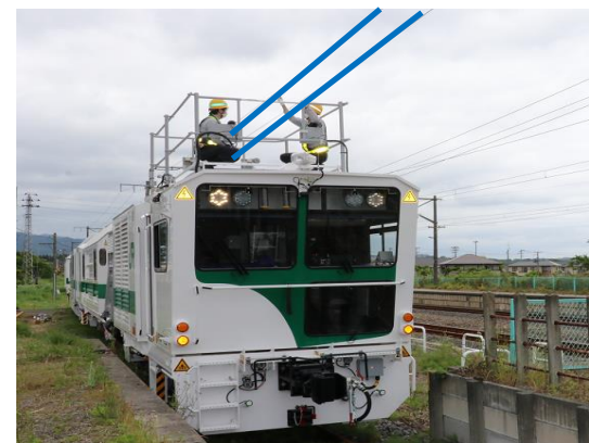
写真8 架線設備点検台
