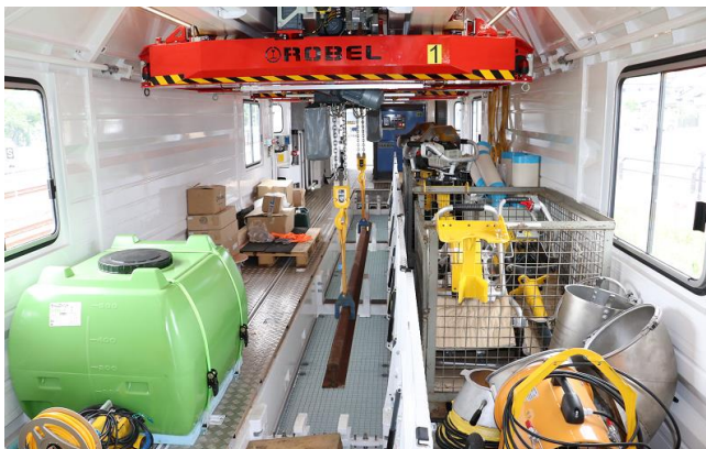
写真7 床下レール収納スペース
